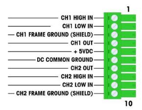
Figure A-76: Flow Meter Connector
