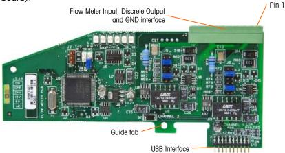
Figure A-75: Flow Meter Option Board
