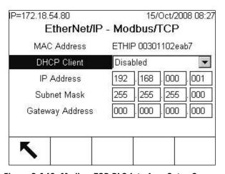
Figure 3-142: Modbus TCP PLC Interface Setup Screen
