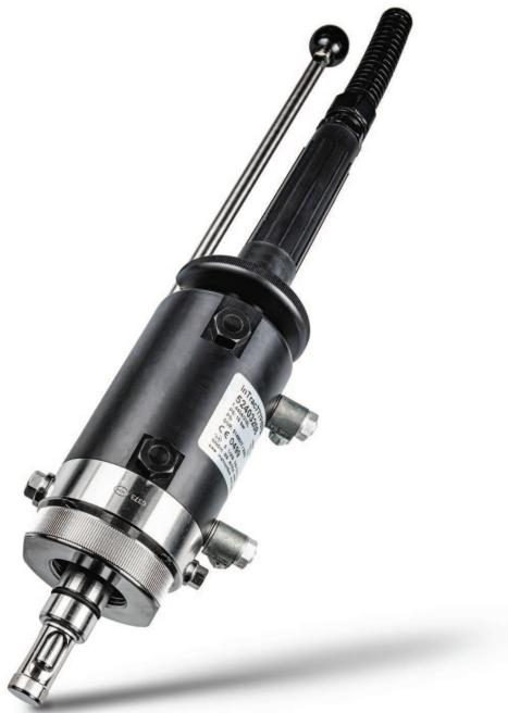
Les supports rétractables InTrac 77X s'adaptent aux sondes électrodes de pH/redox, d'oxygène (dissous) et de conductivité de 12 mm. Le support dispose d'une chambre de rinçage qui permet de rincer, nettoyer et réétailler l'électrode sans interférer avec le procédé. Ce support est doté du système de sécurité breveté Tri-Lock pour la sécurité opérationnelle. L'InTrac 77X est disponible avec différents raccords procédé.
