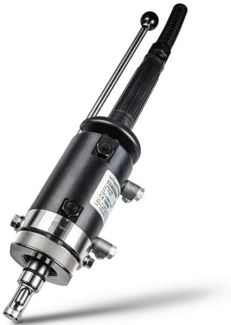
Las carcasas retráctiles InTrac 77X admiten sensores de pH/ORP (Redox), oxígeno (disuelto) y conductividad de 12 mm. La carcasa dispone de una cámara de lavado en la que el electrodo se puede lavar, enjuagar y recalibrar sin interferencias en el proceso. Esta carcasa incorpora el sistema de seguridad patentado Tri-Lock para una mayor seguridad de funcionamiento. La carcasa InTrac 77X está disponible con diferentes conexiones de proceso.
