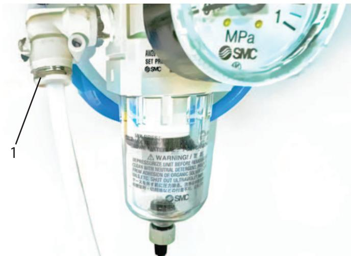
1. Conexión de aire Rc 1/8, compatibilidad con tubos de 6 mm (conector rápido)
