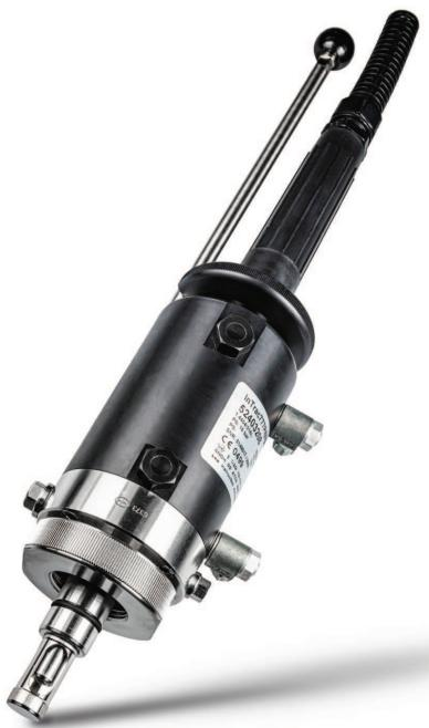
Die Wechselarmaturen InTrac 77X eignen sich für 12-mm-Sensoren für pH/Redox, gelösten Sauerstoff und Leitfähigkeitssensoren. Die Armatur verfügt über eine Spülkammer, in der die Elektrode ohne Prozessbeeinträchtigung gespült, gereinigt und neu kalibriert werden kann. Diese Armatur verfügt über das patentierte Tri-Lock-Sicherheitssystem für Betriebssicherheit. Die InTrac 77X ist mit verschiedenen Prozessanschlüssen erhältlich.
