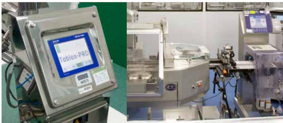
O Tablex-Pro (imagem à esquerda) inspeciona cada pílula e a rejeita se detectar contaminantes de metal. Após o primeiro nível de embalagem, os controladores de peso verificam de forma confiável a integralidade de cada pacote único (imagem à direita).
