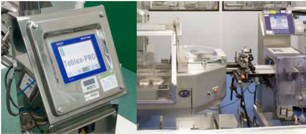
Ein Tablex-Pro-System (links) prüft jede einzelne Pille und schleust Metallfremdkörper aus. Hinter der ersten Verpackungsstation prüfen die Kontrollwaagen zuverlässig jede einzelne Packung auf Vollständigkeit (rechts).
