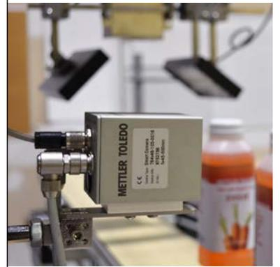
集成于自动过程内的梅特勒-托利多视觉检测系统将验证并收集数据，包括正确的标签显示、标签位置、标签倾斜度、标签 ID、标签注册以及人类可读的文本。
