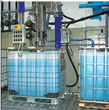
在很多过程中，集成的称重传感器可提供比流量计更好的结果，原因是您在更换材料时不需要对称重传感器进行清洗。预称重批次组件可有效加速生产。梅特勒-托利多称重传感器可精准地控制进入反应器或混合器的液体。
