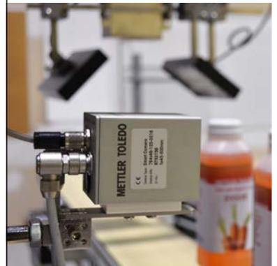
여러분의 자동화 환경으로 통합된 메틀러 토레도의 비전 검사 시스템은 정확한 라벨 표시, 라벨 위치, 라벨의 뒤틀어짐, 라벨 ID, 라벨 등록 및 고객이 읽을 수 있는 문자 등의 데이터를 검증 및 수집합니다.
