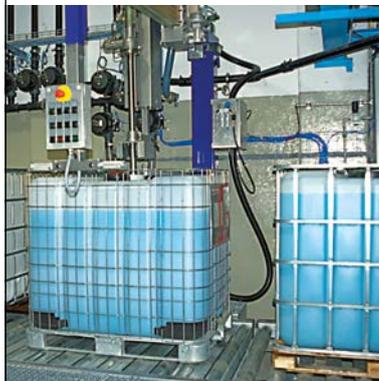
여러 가지 공정에서, 계량 센서가 재료 교체 시 세척이 필요 없기 때문에 통합된 계량 센서가 유량계보다 더 우수한 결과를 제공하는 것으로 나타났습니다. 사전 계량 배치 구성품은 생산 속도를 효과적으로 높일 수 있습니다. METTLER TOLEDO의 로드 셀은 반응기 또는 혼합기로 액체를 첨가하는 것을 정확하게 제어합니다.
