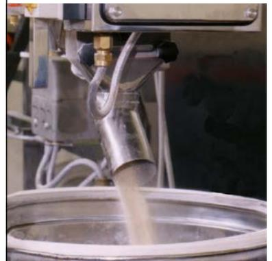
중량이 부피보다 더 일정한 측정을 제공하므로 건조 재료를 계량함으로써 최상의 상태로 가공합니다. 계량 결과에 변수가 보이는 경우, 중량 손실 시스템의 METTLER TOLEDO 자동화 센서 및 METTLER TOLEDO 로드 셀 사용을 고려해보십시오.
