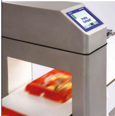
제품에 있는 이물질이 고객이나 다음 공정에 피해를 입힐 수 있는 경우 규정 미준수 제품을 자동으로 리젝트하는 공정 내 금속 검출기 또는 X-ray 검사 시스템을 고려하십시오. 이는 고객뿐 아니라 하류 생산 장비 또는 포장 장비가 손상되지 않게 보호합니다.
