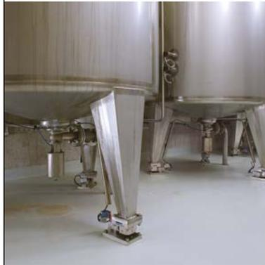
**El pesaje mantiene un control de inventario exacto en tanques, silos y tolvas.**
