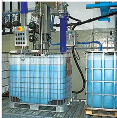
En muchos procesos, se ha observado que los sensores de pesaje integrados proporcionan unos resultados mejores que los caudalímetros, ya que no es necesario limpiar los sensores de pesaje cuando se cambian los materiales. El prepesaje de los componentes del lote puede acelerar de forma efectiva la producción. Las células de carga de METTLER TOLEDO controlan con precisión la adición de líquidos en el reactor o mezclador.
