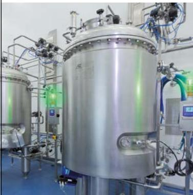
METTLER TOLEDO permite la integración en línea de mediciones analíticas en los sistemas de control de procesos mediante una serie de transmisores adecuados y con un alto rendimiento para las mediciones del pH, el oxígeno disuelto, el CO<sub>2</sub>, la conductividad y la turbidez. Unos resultados continuos, fiables e inmediatos proporcionan la base para un rendimiento optimizado de la fábrica.
