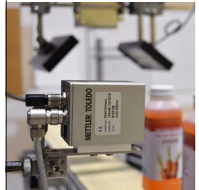
Los sistemas de inspección por visión de METTLER TOLEDO integrados en su entorno de automatización validarán y recogerán datos como la presencia de una etiqueta, además de la posición, la desviación, el ID y el registro precisos de dicha etiqueta, y el texto legible para los humanos.
