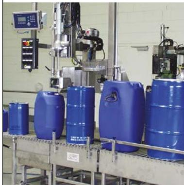
Si su producto es caro, no debería desperdiciarlo a través del sobrellenado del contenedor a granel. Las células de carga, los módulos de pesaje o las básculas de METTLER TOLEDO pueden integrarse con facilidad en la máquina de llenado para una mayor exactitud en entornos seguros y peligrosos, lo que le garantiza unas exactitudes de llenado altas para conseguir ahorros en los costes.
