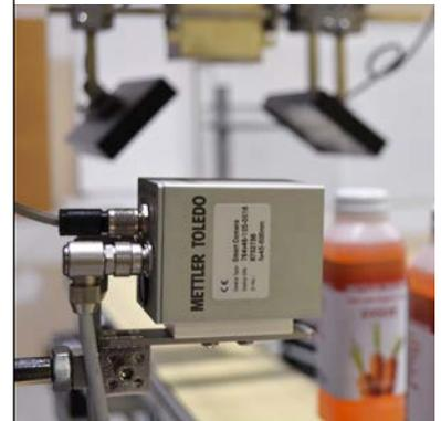
Durch den Einbau optischer Inspektionssysteme von METTLER TOLEDO in Ihre Automationsinfrastruktur können Sie Daten validieren und erfassen, so z. B., ob das richtige Etikett vorhanden ist, ob sich das Etikett an der vorgesehenen Position befindet oder ob das Etikett schief angebracht ist. Etikett-ID, Etikettregistrierung sowie von Menschen lesbarer Text können ebenfalls geprüft und erfasst werden.
