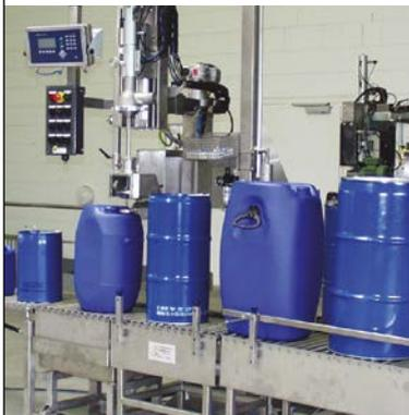
Wenn Ihr Produkt viel Geld kostet, sollten Sie eine Verschwendung durch das Überfüllen von Schüttgutcontainern unbedingt verhindern. Wägezellen, Wägemodule oder Waagen von METTLER TOLEDO lassen sich leicht in Ihre Befüllanlage einbauen, um sowohl in sicheren als auch in Ex-Bereichen präzise Befüllungen durchführen zu können. Auf diese Weise erreichen Sie eine hohe Füllgenauigkeit und sparen Kosten.
