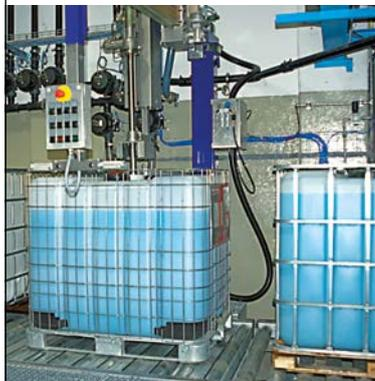
In vielen Prozessen liefern integrierte Wägesensoren nachweislich bessere Ergebnisse als Durchflussmesser, da Wägesensoren bei einem Materialwechsel nicht gereinigt werden müssen. Komponenten zum Vorwägen von Chargen können die Produktion effektiv beschleunigen. Mit METTLER TOLEDO Wägezellen können Sie präzise steuern, wie viel Flüssigkeit Ihrem Reaktor oder Mischer hinzugefügt wird.
