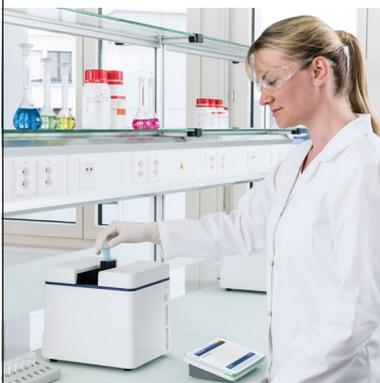
Технология УФ-ВИД спектрофотометрии FastTrack гарантирует постоянную готовность прибора к работе. Время измерения сокращается благодаря тому, что импульсная ксеноновая лампа не требует прогрева. Так как лампа используется только для самих измерений, срок ее службы значительно продлевается.
