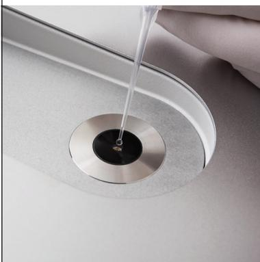
УФ-ВИД спектроскопия микро-объема подходит для образцов малого объема или с большим коэффициентом поглощения. Всего 1 мкл образца позволяет получить достоверный результат. Образец без разбавления (исключает дополнительные ошибки) наносит на измерительную поверхность, и крышка автоматически фиксируется на точно определенной длине пути.
