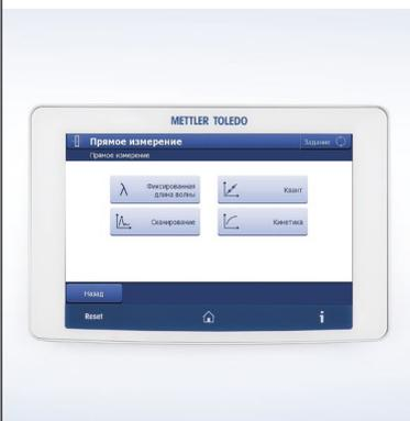
Сканирование спектра, измерение поглощения на фиксированной длине волны, количественные измерения с калибровочными кривыми и кинетические анализы выполняются в любой момент без дополнительных настроек. Начните измерения в одно касание после выбора параметров и метода с помощью технологии «Один клик».
