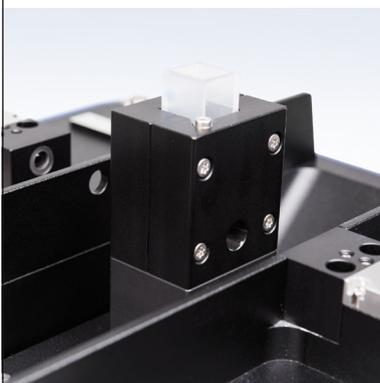
Технология FastTrack УФ ВИД спектрометрии сочетает оптоволокно с матричным детектором и импульсной ксеноновой лампой. Сканирование полного спектра выполняется всего за 1 секунду. Стабильность интенсивности лампы существенно повышает производительность, так как при работе с сериями образцов не требуется проводить многочисленные параллельные измерения.
