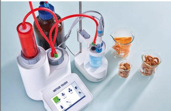
Easy Na 钠含量分析仪不仅能够减少初始投资成本，而且还能降低运营成本。将通常用于氯化物测定的硝酸银 ( $\text{AgNO}_3$ ) 滴定剂替换为更加经济实惠且更加安全的钠标准溶液和试剂。凭借快速的样品测量，节省操作时间并提高工作效率。
