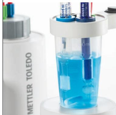
由于采用了标准加入法, 所以无需校准。仅需执行电极的自动浸洗, 便可立即开始分析。
