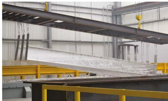
El galvanizado en caliente recubre la superficie de acero con una capa protectora de zinc. Al sumergir el acero en un baño de zinc fundido, el proceso cubre los componentes de acero por completo, por dentro y por fuera. El acero galvanizado proporciona una protección contra la corrosión sin necesidad de mantenimiento durante toda la vida útil de la báscula.
