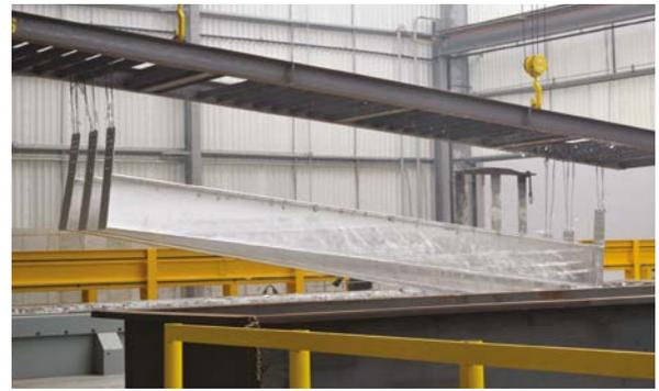
Feuerverzinkung beschichtet die Stahloberfläche mit einer Schutzschicht aus Zink. Durch Eintauchen des Stahls in ein Bad aus geschmolzenem Zink werden die Stahlkomponenten innen und aussen vollständig beschichtet. Verzinkter Stahl bietet über die gesamte Lebensdauer Ihrer Waage hinweg wartungsfreien Korrosionsschutz.
