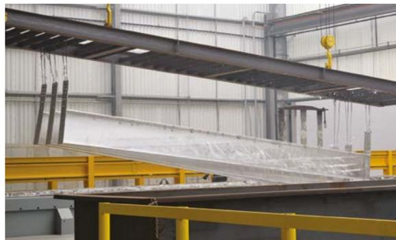
La galvanisation par immersion à chaud recouvre la surface en acier d'une couche protectrice de zinc. En plongeant l'acier dans un bain de zinc fondu, le procédé recouvre complètement les composants en acier, à l'intérieur comme à l'extérieur. L'acier galvanisé offre une protection contre la corrosion ne nécessitant aucun entretien pendant toute la durée de vie de votre pont-bascule.
