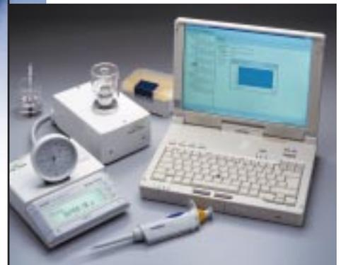
**Evolutive.** Avec le kit de calibrage de pipettes METTLER TOLEDO et le logiciel PC, vous transformez la SAG105 en une performante balance de calibrage de pipettes.
