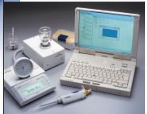
**Ausbaubar.** Mit dem METTLER TOLEDO Pipettenkalibrierkit und der PC-Software bauen Sie die SAG105 zur leistungsfähigen Pipettenkalibrierwaage aus.
