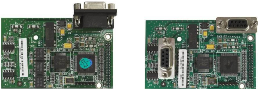
图 4-39: PROFIBUS 防尘式（左）和面板式（右）接口板
