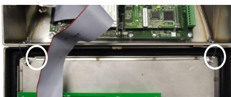
图 4-7: 上下盖接地线位置
