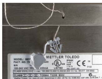
Figura A-99: Sellado externo de la caja para ambientes adversos
