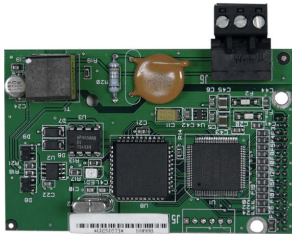
Figura A-87: Módulo de interfase de PLC de Allen Bradley RIO
