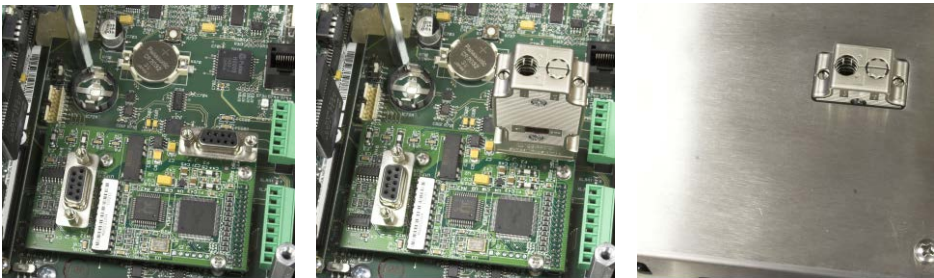
Figura A-80: Conector de módulo de PLC PROFIBUS para caja para montaje en panel
