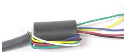
Figura A-16: Núcleo de ferrita sobre el cable de celda de carga analógica
