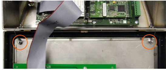
Figura A-7: Ubicaciones de la fijación de la cinta de conexión a tierra
