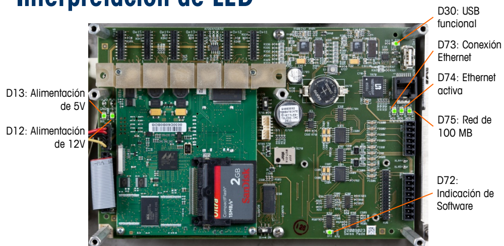
Figura A-37: Ubicaciones de los LED del PCB principal
