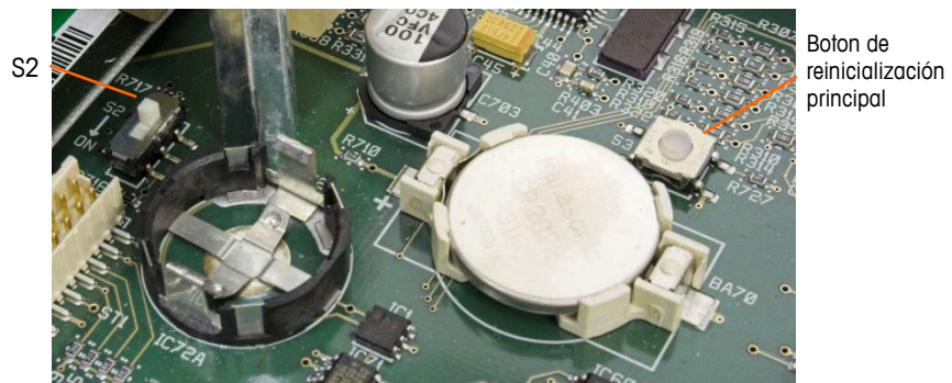
Figura A-36: Ubicación del botón principal de reinicialización del PCB principal
